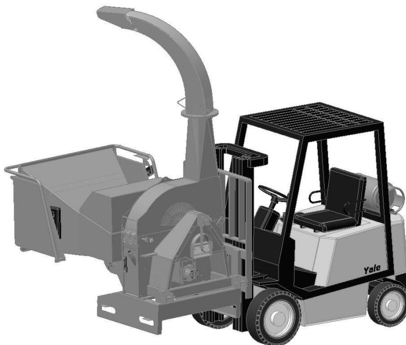
Figur 2 Løftning med gaffeltruck
